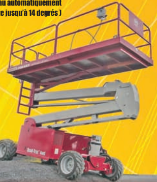
Titan Boom 40-S Capacité 4000 lbs 22' x 76" (plancher) 46' hauteur de travail
